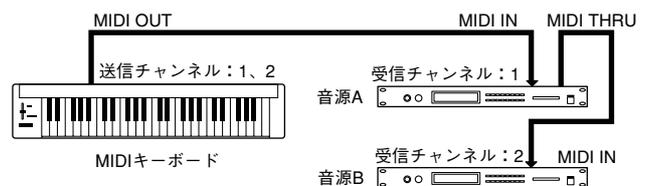
RS-5/9 を音源モジュールとして使うとき、最大 16 チャンネル分使えます。RS-5/9 のように 1 台で複数のチャンネルを受信し、それぞれ演奏できる音源モジュールのことを「マルチティンバー音源」といいます。
